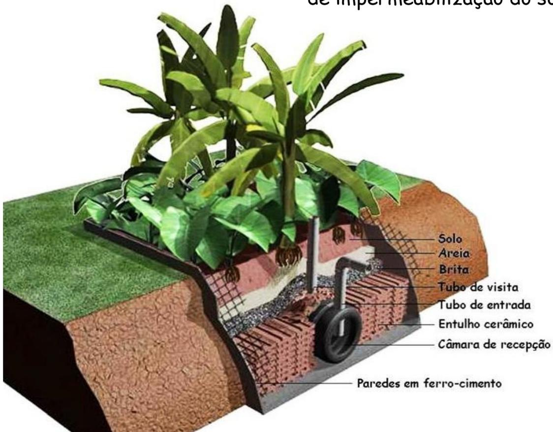
Já para a trincheira (buraco retangular cavado) da Eco Fossa é necessário a utilização de um material para impermeabilizar o solo.
