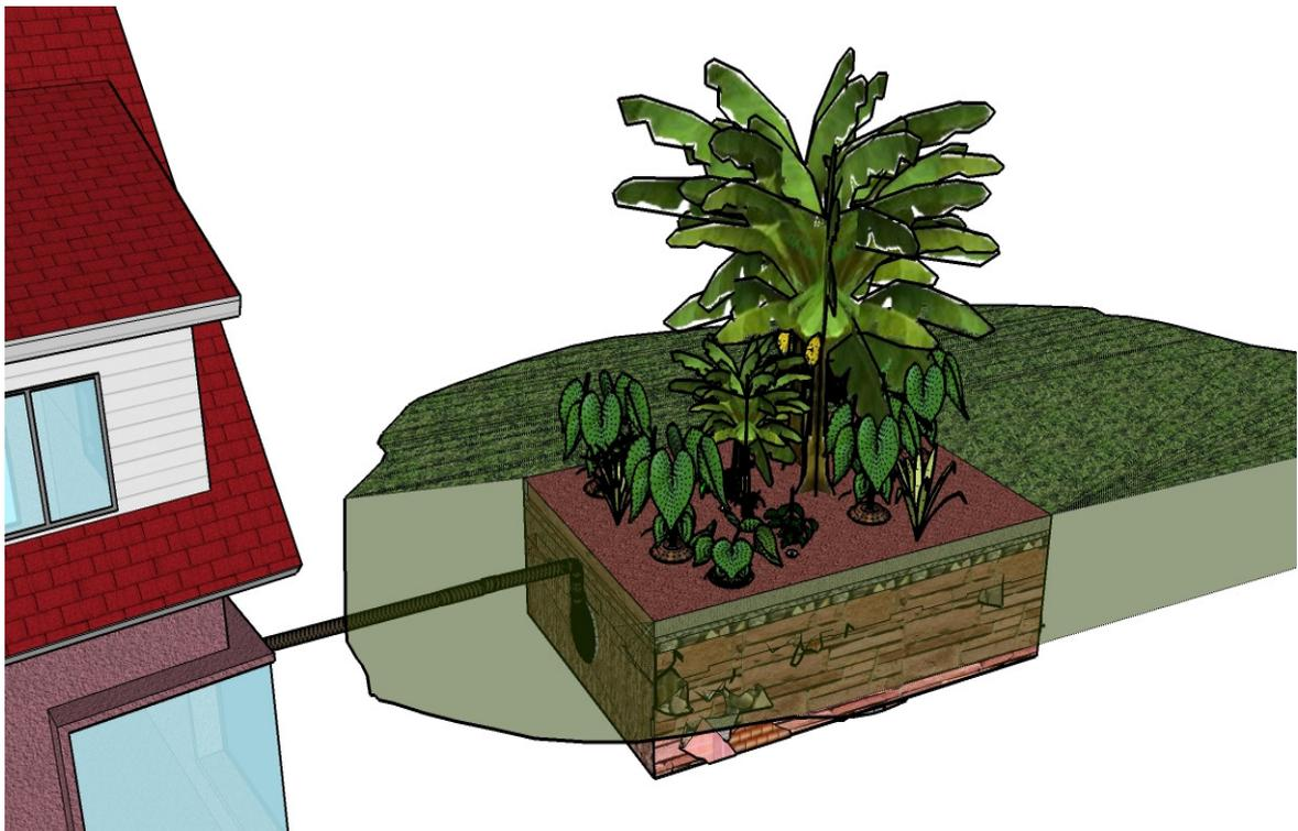
7- Plantas: após a decomposição anaeróbia da matéria orgânica e mineralização, há a absorção dos nutrientes e da água pelas raízes. Os nutrientes deixam o sistema incorporando-se à biomassa das plantas.
