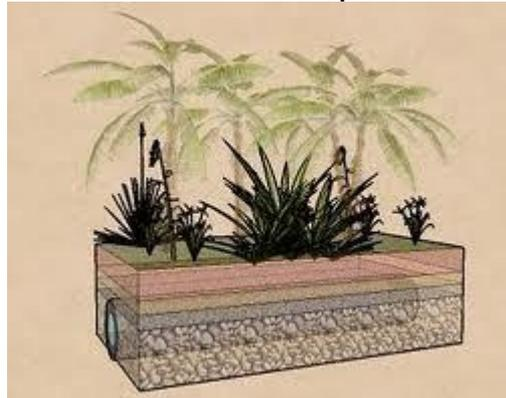
1 - Trincheira: cavar sempre 1m de profundidade por 2 m<sup>2</sup> por pessoa e impermeabilizar o solo;
